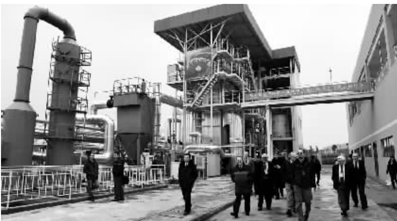
华中科技大学正与神华集团、东方电气集团携手,联合开发十万吨级和百万吨级富氧燃烧大规模燃煤碳捕获技术,为我国应对气候变化重大战略需求进行技术储备。
